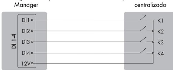
Imagen 13: Conexión de un receptor estático de telemando centralizado a la entrada digital DI 1-4 del SMA eCharger, que debe configurarse como SMA System Manager
